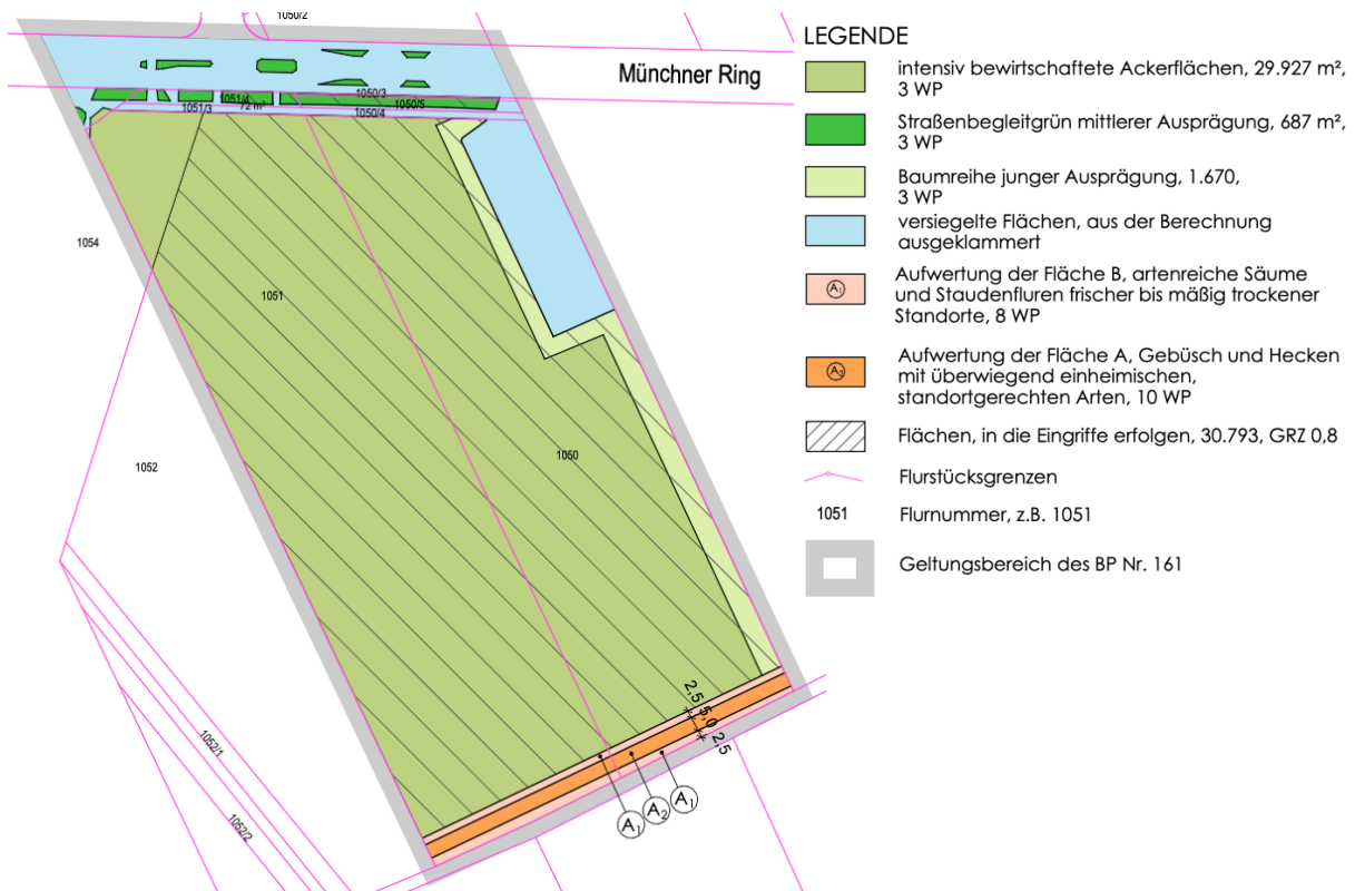
Abbildung 3: Versiegelte Flächen (blau), Flächen mittlerer Kategorie (hellgrün, grün, dunkelgrün) im Bestand mit und ohne Eingriffe (graugestrichelt) sowie der zur Aufwertung festgesetzten Ausgleichsfläche (rosa & orange)
